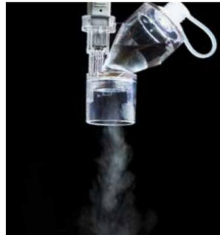
Cuando se aplica energía, la pletina de abertura vibra **128.000 veces por segundo** generando una neblina de baja velocidad de partículas diminutas formadas por gotas del tamaño adecuado (1-5µm)<sup>1</sup> para lograr un mayor depósito en los pulmones del medicamento.<sup>2,3</sup>
